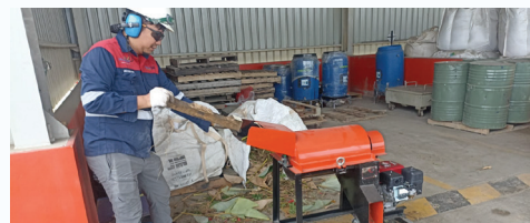
Pemantauan dan pengukuran lingkungan di IBP (ILSS, KGTE, IRB) serta peningkatan kapasitas pengomposan menggunakan mesin crusher
